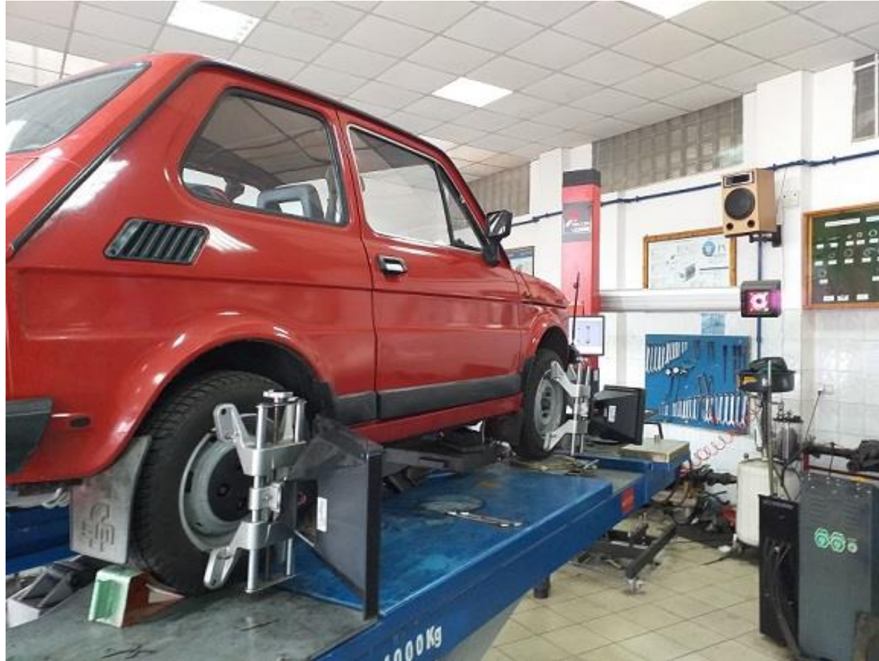
Urządzenie do geometrii kół 3D wraz z podnośnikiem.
